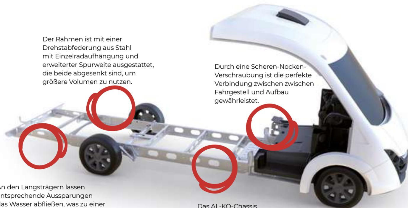
Der Rahmen ist mit einer Drehstabfederung aus Stahl mit Einzelradaufhängung und erweiterter Spurweite ausgestattet, die beide abgesenkt sind, um größere Volumen zu nutzen.
