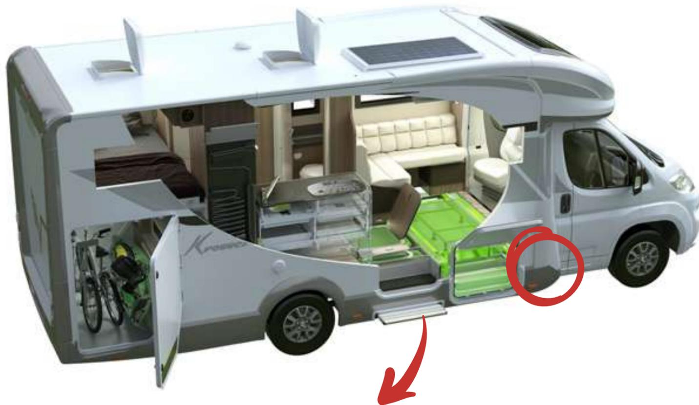
Isolierte und beheizte Frisch- und Abwasserbehälter im Doppelboden über der Hinterachse.
