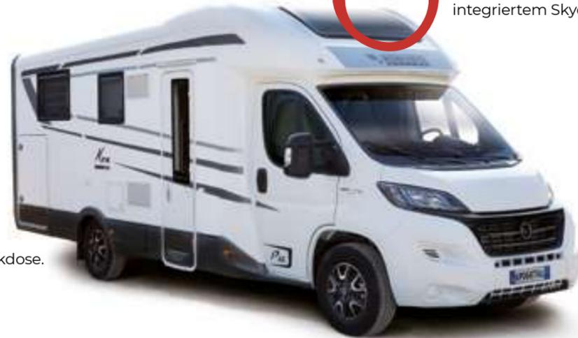
Halbintegrierte Dachhaube mit integriertem Skydome.
