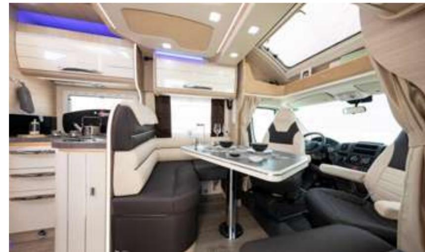
Die Fahrerhausitze können um 180° gedreht werden, wobei die Bezüge auf die Polsterung abgestimmt sind. Sitze aus Polyurethanschaum mit doppelter Dichte.
