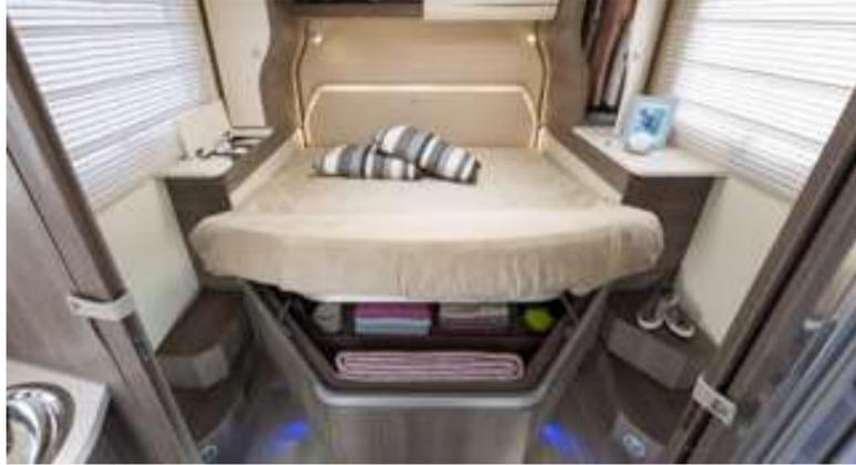
Hinteres Bett mit elektrischer Hubvorrichtung: Die Höhe so verstellen, dass der Platz dort zu Verfügung steht, wo er gebraucht wird: mehr Volumen in der Garage oder im Schlafzimmer (Modelle 58, 59).
