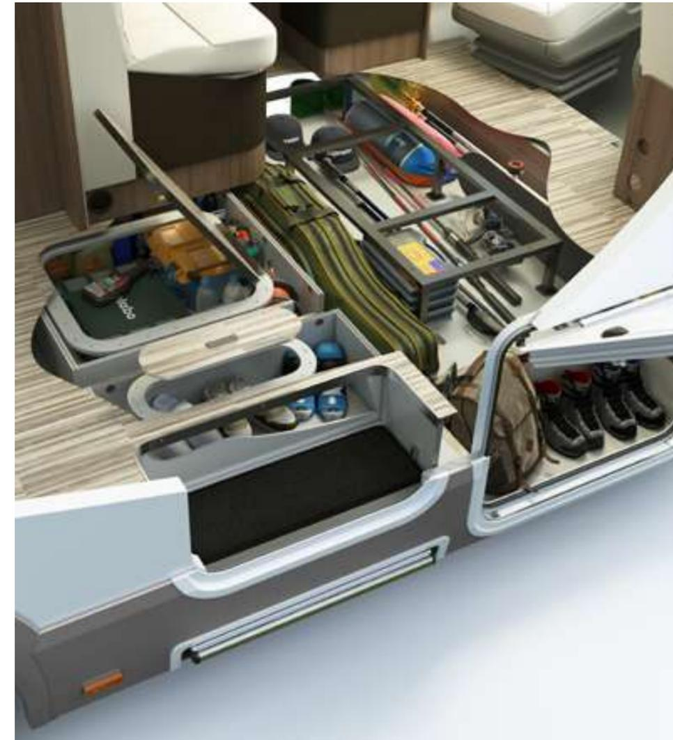
Größerer Stauraum dank des technischen Doppelbodens mit praktischen Luken für die Versorgung von Gegenständen und Flaschen, im vorderen und hinteren Fahrzeugteil. Auf der Außenseite sind weitere Stauräume unter aufklappbaren Schwellern vorgesehen.
