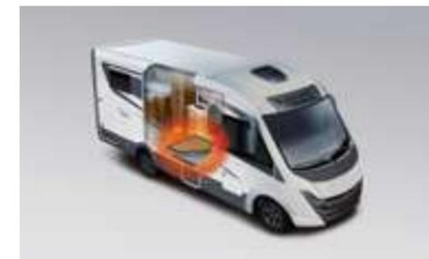
**Fußbodenerwärmung** mit selbstregelnden Heizkabeln (K-yacht Teknoline und Kea M und P) oder mit Heizfolie (K-Yacht Tekno Design) je nach Modell für eine über die gesamte Bodenfläche verteilte Wärme.
